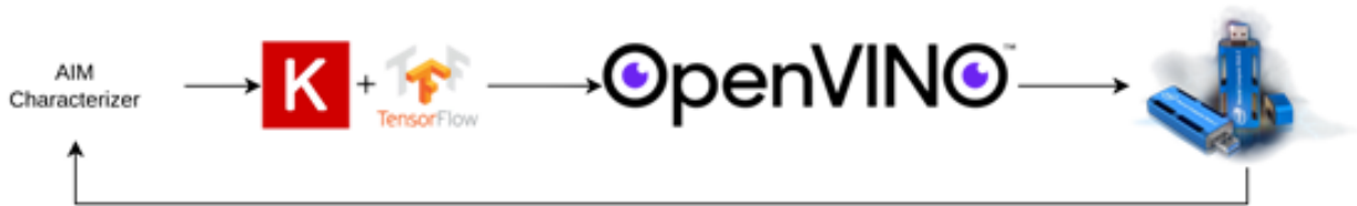
Abbildung 59: Schematische Übersicht der automatischen Hardware-Charakterisierung als Vorbereitung für eine hardwarebewusste Vorhersage der Ausführungszeiten von neuronalen Netzen.
