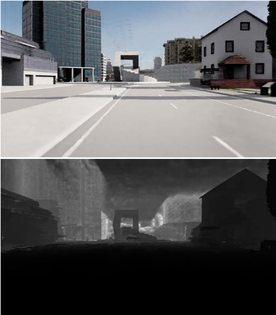
Abbildung 10: Erzeugte Ansicht aus der 3D-Rekonstruktion einer synthetischen Szene (links Farbbild, rechts Tiefe). Es wurden synthetische Szenen zur Evaluierung gegen die bekannte Ground Truth verwendet.
